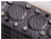
チップを溶かして口金から押し出す
